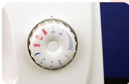
09- Observe o Seletor de pontos. Ele apresenta os pontos que a máquina oferece, de acordo com a numeração.
