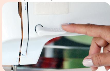
07- Observe a foto da Alavanca do retrocesso. Por meio dela faz-se o arremate na costura.
