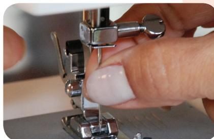
15- que deve ser colocada voltada para a frente da máquina.
