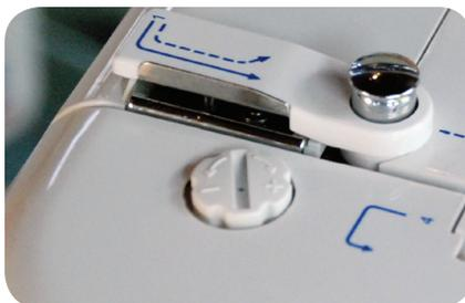
05-Observe o Ajuste da pressão do pé calçador. Caso precise ajustar sua pressão, gire o parafuso de ajuste, utilizando uma moeda.
