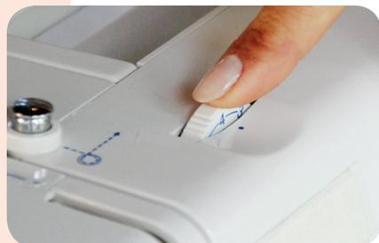
04- Veja o Seletor de tensão de linha. A tensão controla as linhas que se amarram entre si para formar um ponto na máquina de costura.
