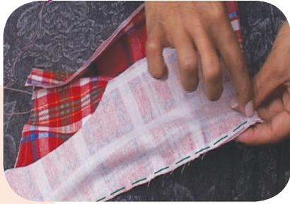
**Ponto de alinhavo (ou Ponto adiante):** é utilizado para alinhar duas ou mais partes de tecido, bolsos, galões e para marcar linhas. É executado da direita para a esquerda. Os pontos são alternadamente visíveis, no lado de cima e no lado de baixo. O comprimento dos pontos depende da resistência que eles precisam ter. Os muito curtos servem para franzir ou embeber.
