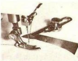
Bitola de costuras. É fixada na base e regulada para uma dada distância em relação à agulha.
