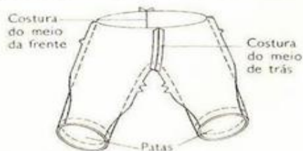
Grav. 4. Ligação da parte de trás à da frente.
