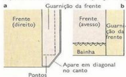
Grav. 3. Apare a guarnição em diagonal nos cantos. Vire para o direito e acabe a bainha.
