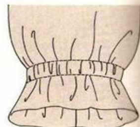
Bainha (com cabeção) para o elástico
