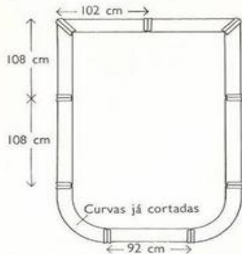
Grav. 4. Corte catorze tiras: quatro de 102 cm de comprimento, oito de 108 cm e duas de 92 cm. Una-as às peças curvas.
