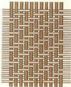
Um tecido de estrutura em diagonal pode formar uma «lista» em viés muito pronunciada.
