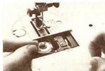
Enquanto exerce pressão sobre a bobina com uma das mãos, com a outra segure a linha e leve-a até à ranhura.
